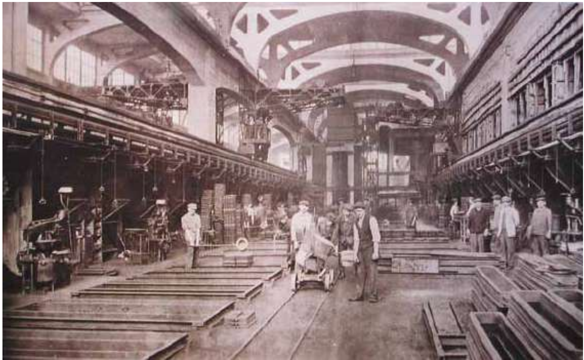
Fig. 5 – Interior da Fundição: instalação de fabrico de moldes e de baldes de transporte de matéria fundida.
